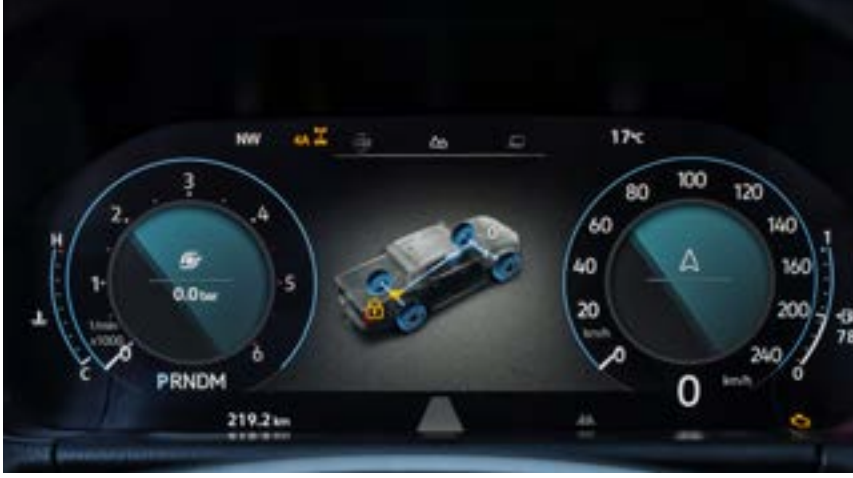
01 Tüm Amarok modellerinde 12,3" (31,2 cm) renkli ekrana sahip dijital gösterge paneli bulunuyor.
