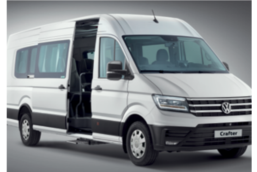
Sıkışmaya karşı güvenlik sistemli otomatik kayar kapı ve basamak: Özel tasarlanmış otomatik kapı, hem sürücü tarafından hem de uzaktan kumandayla kontrol edilebiliyor. Sıkışmaya karşı çift güvenlik sistemli kapı, acil durumlarda içeriden ve dışarıdan açılabilir.
