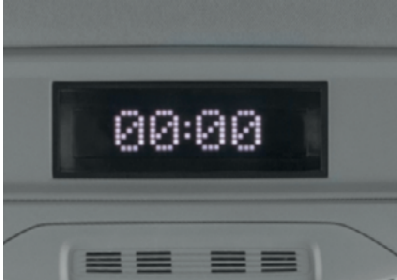
Fonksiyonel LED saat: Dış sıcaklık, tarih ve saat bilgisini dönüşümlü olarak veren LED saat yol bilgisayarına entegre şekilde çalışıyor.
