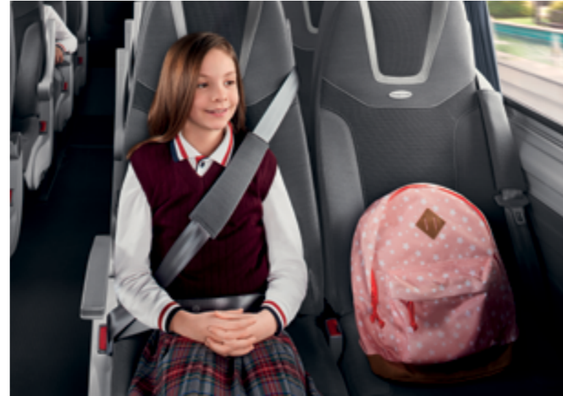
Otomatik yükseklik ayarlı 3 noktadan gergili emniyet kemerleri: Crafter Okul modellerinde standart olarak sunulan ve yolcunun omuz yüksekliğine göre konumunu otomatik olarak ayarlayan emniyet kemerleri özellikle çocukların çok daha güvenli bir şekilde seyahat etmesini sağlıyor.
