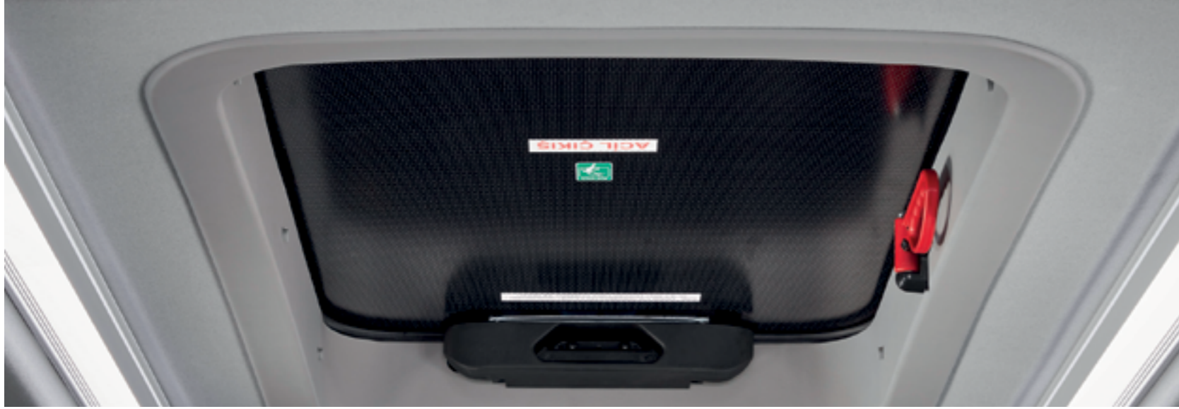
Manuel açılabilen acil çıkış kapağı: Crafter'daki acil çıkış kapağı elle açılabilir yapıyla ekstra havalandırma imkânı sunuyor.
